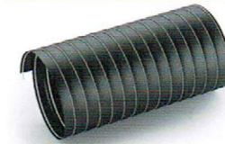
TERMOFLEX 150°C 913072 Manguera de tejido de fibra de vidrio recubierto de neopreno con espiral de acero galvanizado, para aspiración de humos y aire caliente.
