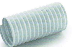
TERMORESISTENTE KLL 125 913068 Manguera de tejido de poliéster recubierto de PVC con espiral de acero galvanizado entre las dos capas de tejido, para aire acondicionado, aspiración de humos y aire caliente.
