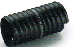
SUPERFLEX PU PLUS HMR 913064 Manguera de POLIURETANO (PU) con espiral de acero cobreado, para aspiración y transporte de polvo, virutas y material abrasivo.
