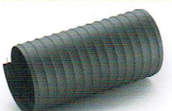
TERMORESISTENTE PU 200°C 912955 Manguera de tejido de poliéster recubierto de PU con espiral de acero galvanizado entre las dos capas de tejido, para aspiración y transporte de aire caliente.
