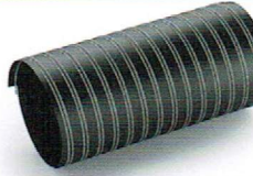
TERMOFLEX 150°C DOBLE CAPA 912821 Manguera de doble capa de tejido de fibra de vidrio recubierto de neopreno con espiral de acero galvanizado, para aspiración de humos y aire caliente.
