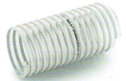
OREGON PU EST ANTISTATICO 911196 Manguera de Poliuretano (PU) poliéster con espiral de PVC rígido e hilos de cobre para función antiestática, para aspiración y transporte de materiales abrasivos y alimentos secos.
