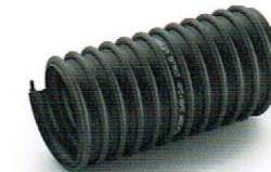
DETROIT 911042 Manguera de caucho termoplástico con espiral de PA6 resistente al aplastamiento y soporte textil en poliéster, para aspiración de gases de escape de vehículos, tanto para el suelo como para enrolladores suspendidos.
