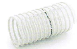
OREGON PU ET 911003 Manguera de Poliuretano (PU) Poliéter con espiral de PVC rígido, para aspiración y transporte de materiales abrasivos y alimentos secos.
