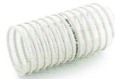
OREGON PU ET ANTISTATICO 911011 Manguera de Poliuretano (PU) Poliéter con espiral de PVC rígido e hilos de cobre para función antiestática, para aspiración y transporte de materiales abrasivos y alimentos secos.
